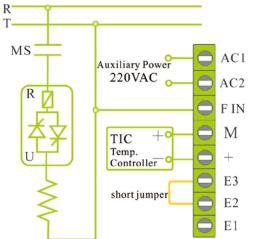
3. Input control signal 4-20mA , external VR control . applied for JK3842S1、JK3856S1、JK3872S1線路。 R
